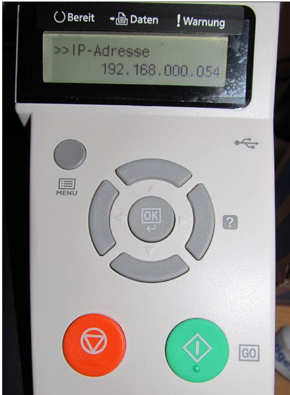
Abbildung 4.9 Netzwerkkonfiguration eines »Kyocera Mita FS-1370DN« über das Bedienfeld
