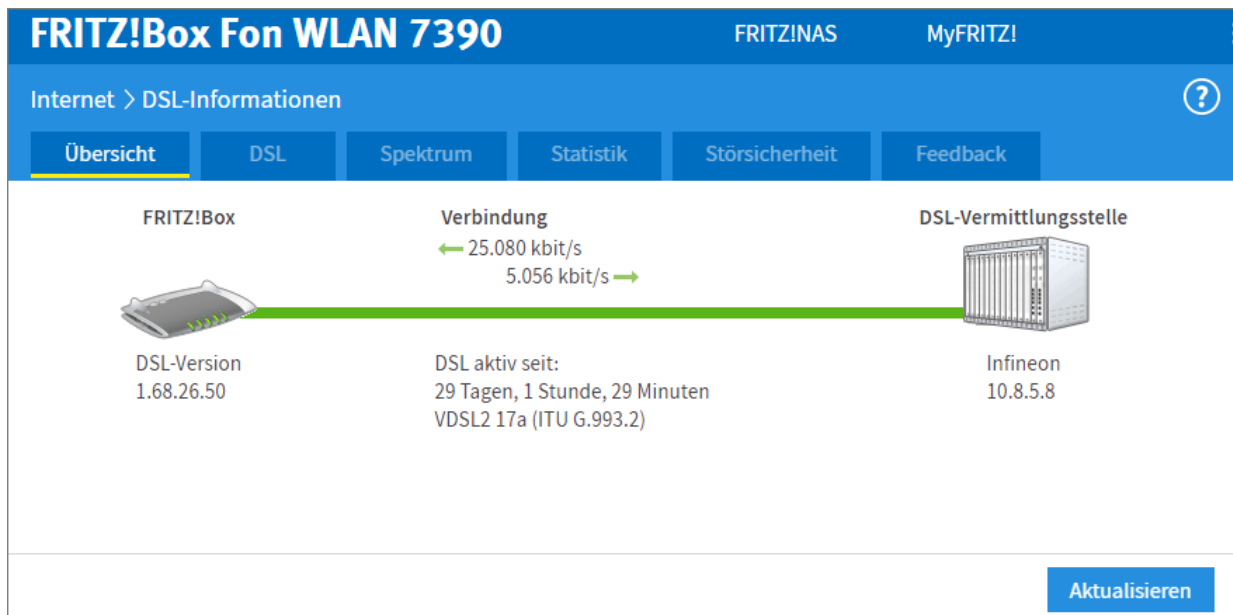
ADSL-Beispiel über FRITZ!Box mit 25Mbit/s Download- und 5 Mbit/s Uploadgeschwindigkeit
