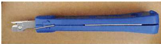
LSA Anlegewerkzeug für Patch Panels
